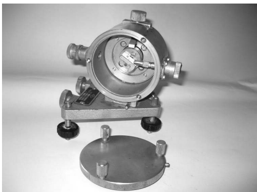
Рентгеновская камера для исследования поликристаллов (РКД – рентгеновская камера Дебая).
